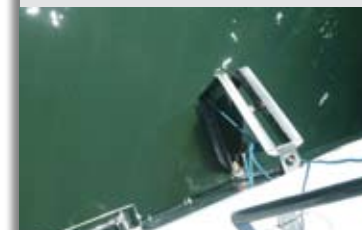
Las dos palas de timón son pivotantes, lo que que facilitará la preparación del barco para el remolque.
