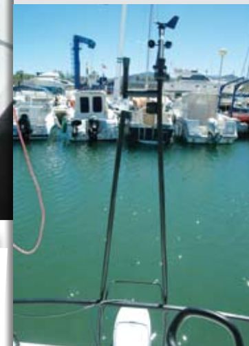
La popa integra un soporte que se eleva para dar apoyo al mástil cuando se abate y a las antenas del barco.
