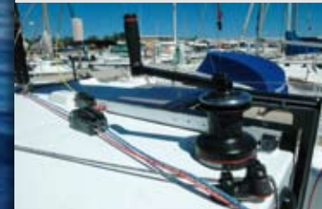
La maniobra se organiza alrededor de un único winche Harken 20 ST, lo que simplifica el acastillaje pero requerirá una buena organización de los cabos.
