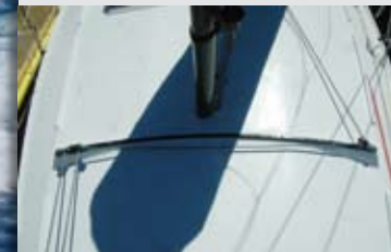
El carro del foque autovirante facilita la maniobra y ejerce, además, de bao estructural.
