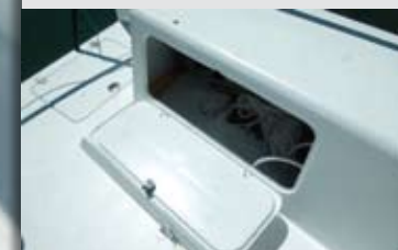
El interior de la bancada de babor se destina a un amplio cofre de apertura lateral con volumen suficiente para guardar cabos y defensas.
