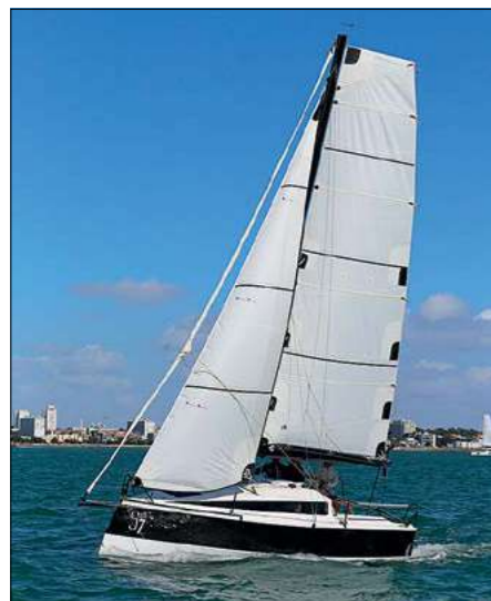
▲ Le gréement carbone allège le bateau et facilite le mâtage par la même occasion.
